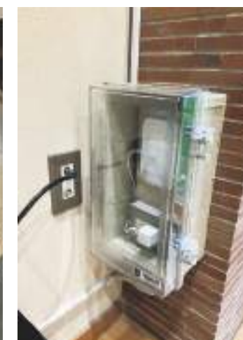
センサー保護の為、カバーも設置
